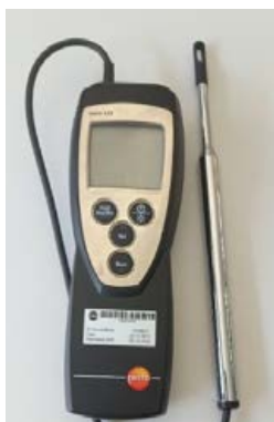
Fig. 2: Anémomètre à fil chaud et détail de la sonde.
