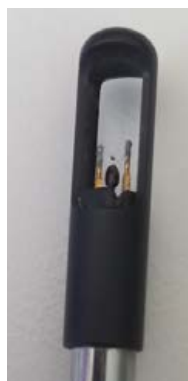
Fig. 2: Anémomètre à fil chaud et détail de la sonde.
