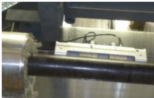
Fig. 4 Démontage du calorifugeage et pose de la réglette de mesure [source : Planair SA]
