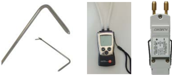
Fig. 2 Différents appareils de mesure de pression (de gauche à droite): tube de Pitot, différentiel de pression, capteur de pression/convertisseur pour data logger.
