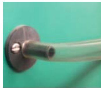
Fig. 3 Prise de pression statique (téton) et flexible en pvc ou silicone (sur la conduite d'air).
