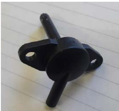
Abb. 8 Abmessungen eines Druckhahns, der in die Leitung eingeführt wird
