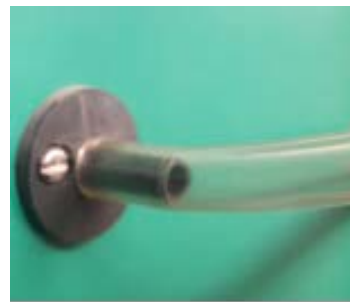
Abb. 3 Hahn für statischen Druck (Nippel) und PVC- oder Silikon-schlauch (an der Luftleitung).
