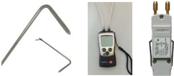
Abb. 2 Verschiedene Druckmessgeräte (von links nach rechts): Pitot-Rohr, Differenzdruckgerät, Druckwandler/Konverter für Datenlogger.
